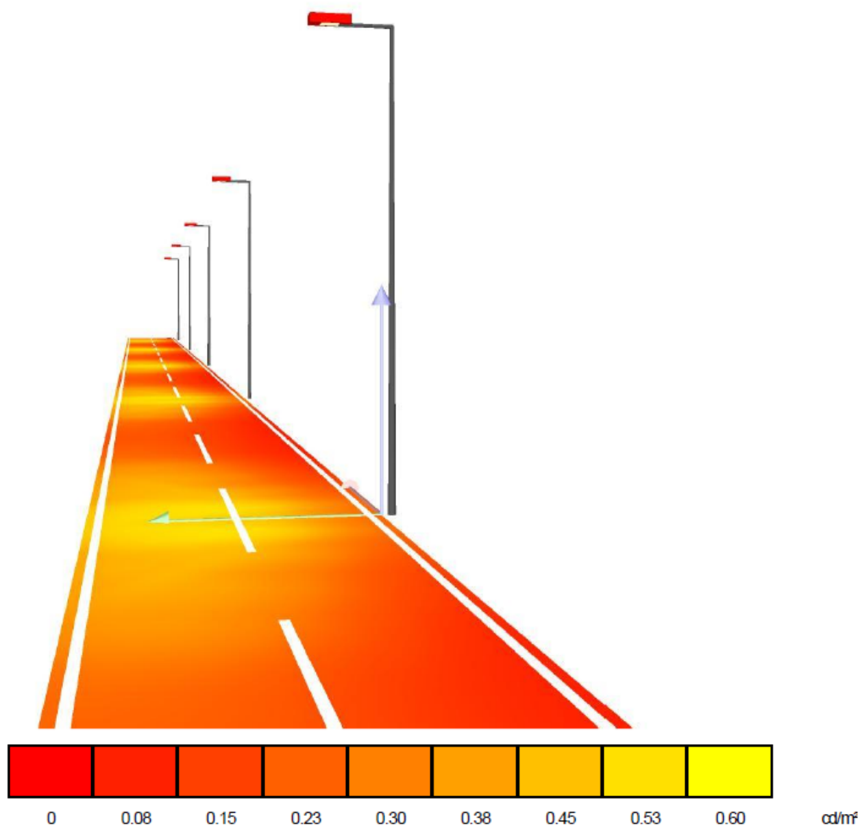
Fig. 100– Output grafico della modellazione del tratto con scala cromatica della luminanza
