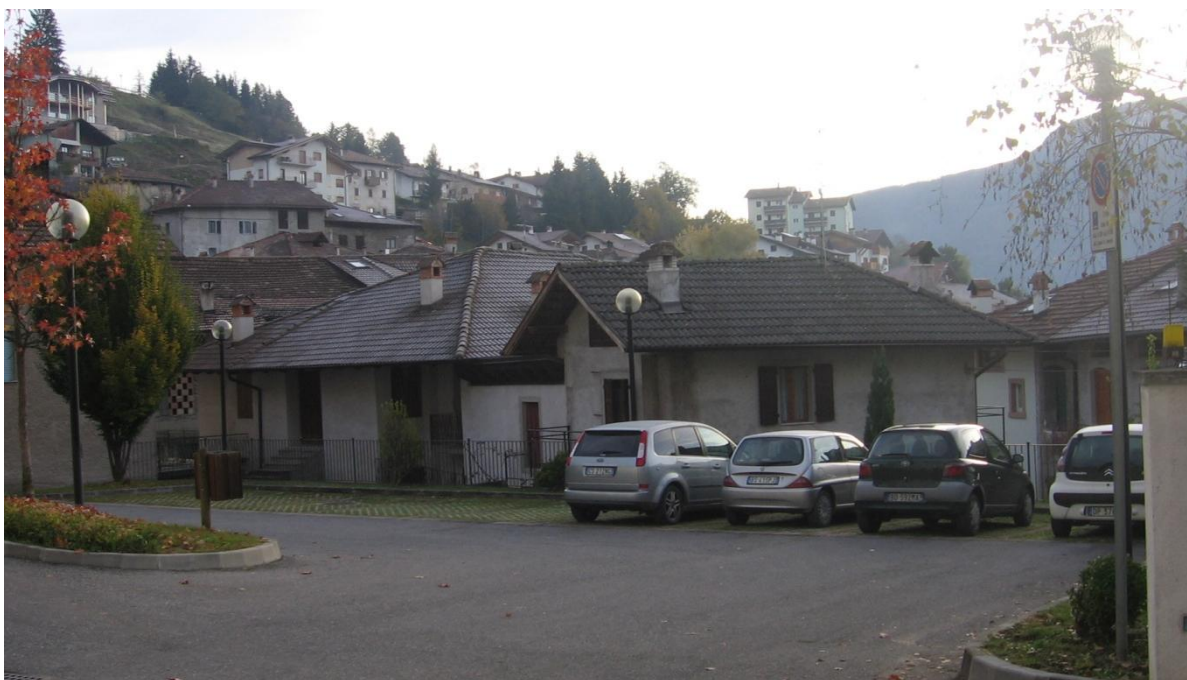
Fig. 60 – Punti luce presenti nel piazzale antistante il municipio di Stenico con installate lampade ai vapori di mercurio della potenza di 125 W. Questo corpi illuminanti sono classificati di classe C secondo la LP 16/07
